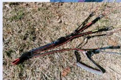
進行方向に対して流線型になるような加工されたビュレットライザーは空気抵抗を減らして滑空性能を向上する。
