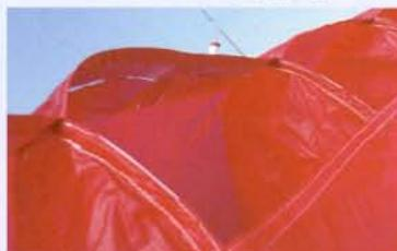
ハイスピードインテークバルブは通常の飛行状態では裏側の弁により閉じられている。
