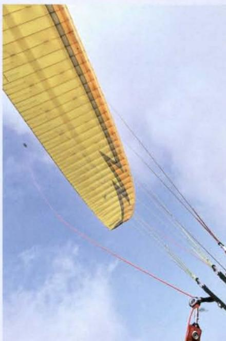
トレーリングエッジのハーフリブ(ノバはミニリブと呼んでいる)により、後縁のシャープな形状を整えている。インテーク下部の色が濃くなっている部分がラムエアポケットだ。
