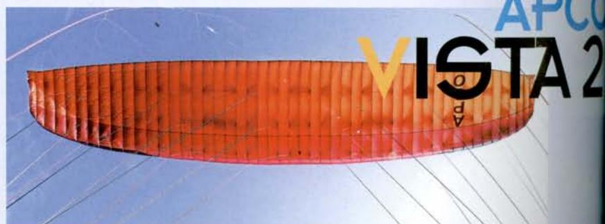
アスペクトは実測で5.06、リブを繋げる短いサポートテープとダイアゴナルリブで補強したキャンビーに3ライナーを組み合わせる。
