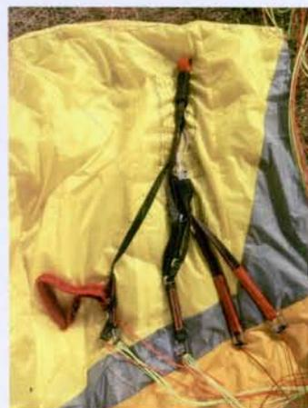
ライザーはA/B/Cの3列ラインコンセプトを採用。Aは翼端折り専用のA'を持つ、変則4本ライザー(2A+1A'/4B/3C)となっている。
