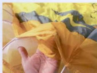
リーディングエッジのインテーク下面は同素材のポケットを装備、ラムエアで膨らみインテーク下部の厚みを増し強度を向上、アクセル使用で迎角が変化した時に効果を発揮する。
